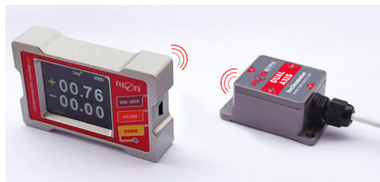
WMI420 外部无线连接双轴倾角分离式测量 / 测量距离 10m 量程 \pm 90^\circ (长度 0-700mm/m)
